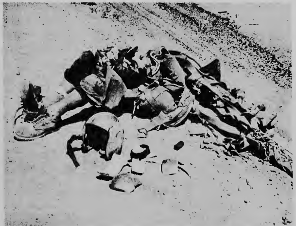
Dos científico aki ta check si tur cos na “curpa” di e dummy ora qu e prueba ta cual nan a sometela a falla, siendo hihá a cabo cu un velocidad mas haltu qu sonido. Nota con e helm a bin para net banda di e sapatu. Cualquier hende por imagina nan si na lugar di e dummy, tabatin un ser humano na e parachute.....
